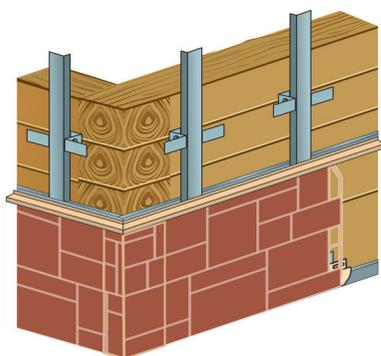
Установите отлив после завершения монтажа последнего (верхнего) ряда фасадных панелей.
