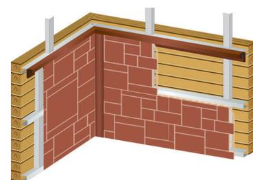
Для завершения монтажа панелей закрепите J-профиль в верхней точке. Введите панель в J-профиль.
