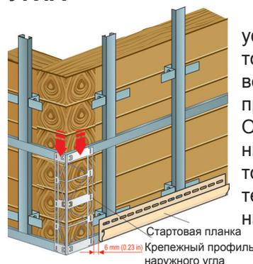
Строго горизонтально установите на стену стартовые планки и строго вертикально - крепежные профили наружного угла. Оставьте между крепежным профилем и стартовой планкой зазор для температурного расширения 6 мм.
