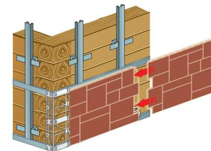
**3.2** Вторую панель заведите в стартовую планку и вплотную придвиньте ее к первой закрепленной панели, чтобы получить естественный рисунок.
