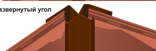
Используйте два J-профиля для обрамления внутреннего угла. Закрепите гвоздь или саморез в верхней части перфорации. Остальные саморезы устанавливайте по центру отверстий. Шаг монтажа выдерживайте 150-200 мм. Вставьте фасадную панель в J-профиль.
